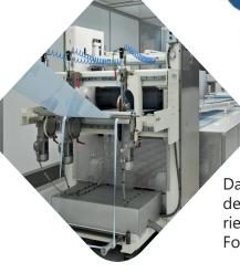
Das Regranulat wird wieder in den Herstellungsprozess integriert und in die Mittelschicht der Folie MEDPETG - EF extrudiert.
