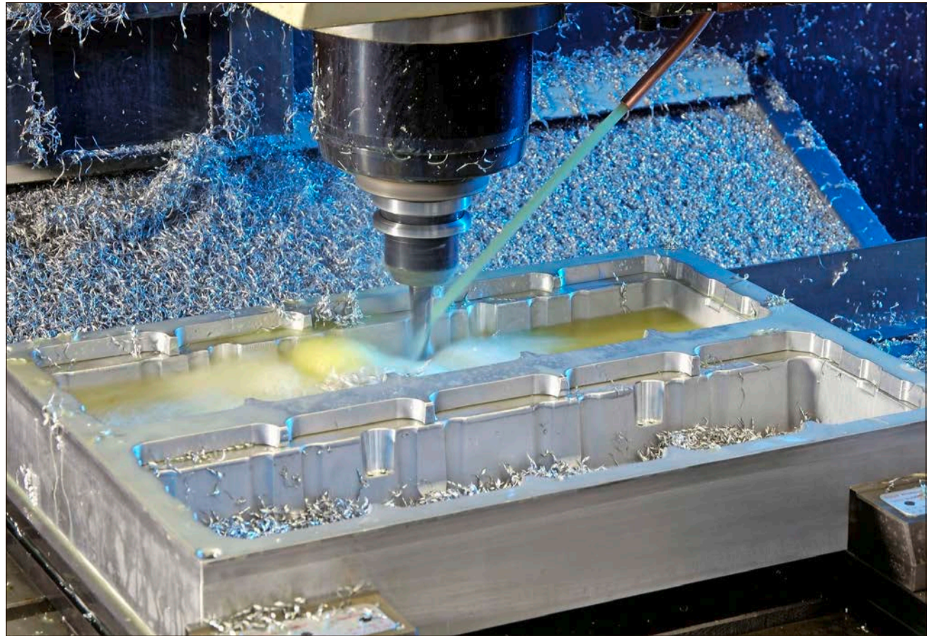
Die Werkzeuge für die Produktion werden im eigenen Haus hergestellt – beispielsweise durch Fräsen. Bild zvg
